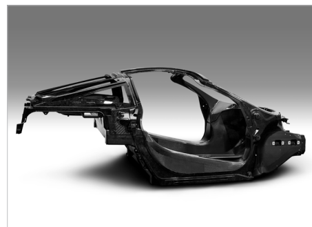
Rohcarrosserien aus CFK sind zwar ultraleicht und weisen hohe Torsionsfestigkeit auf. Sie sind aber auch überproportional teuer und punkto Recycling den metallischen Werkstoffen unterlegen. Quelle: McLaren
