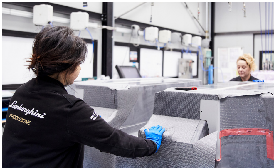
Die Produktion von kohlefaserverstärkten Carrosserieteilen (CFK) ist aufwendig, da in der Produktion viel Handarbeit und Know-how gefragt ist. BMW hat den CFK-Carrosseriebau wenigstens teilautomatisiert. Quelle: Lamborghini
